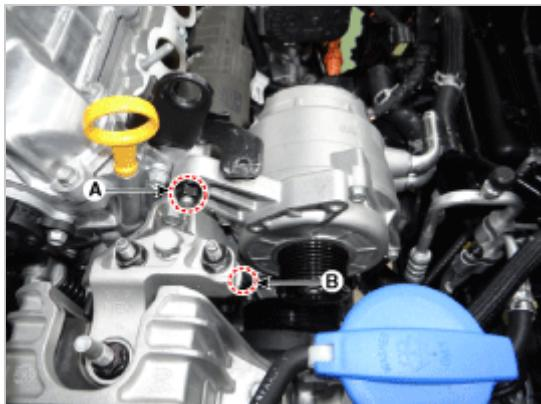
11. 拆卸HSG支架(A)，并拆卸HSG。
